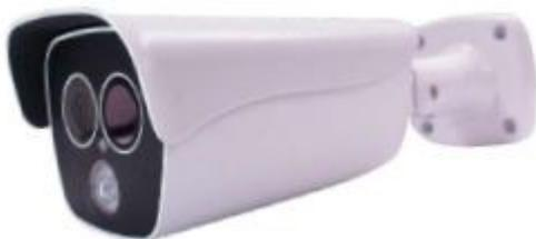
Dotata di una telecamera Dual Vision a obiettivo fisso, questa serie offre una soluzione all-in-one particolarmente vantaggiosa per la videosorveglianza a lunga distanza insieme alla tecnologia Thermal, per il controllo della temperatura corporea.
